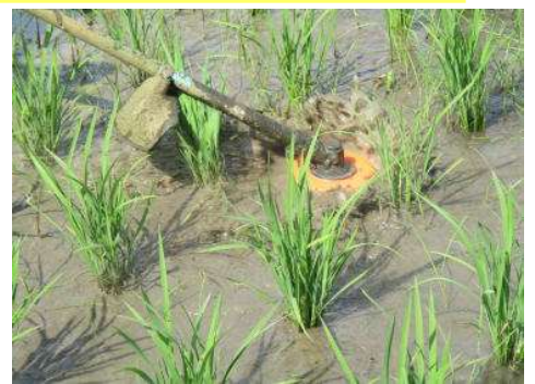
上部の円盤がガードし苗を痛めない
